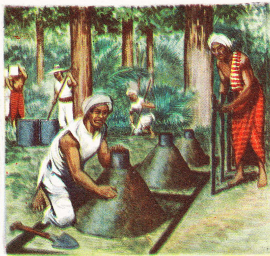
Des foyers, coiffés d'entonnoirs de tôle, par où s'échappe la fumée qui sèche le latex.
